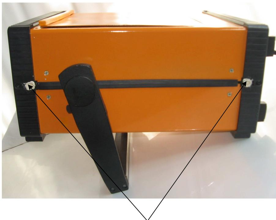
Рис.2 Место пломбировки дефектоскопа ультразвукового “УД2-12”
